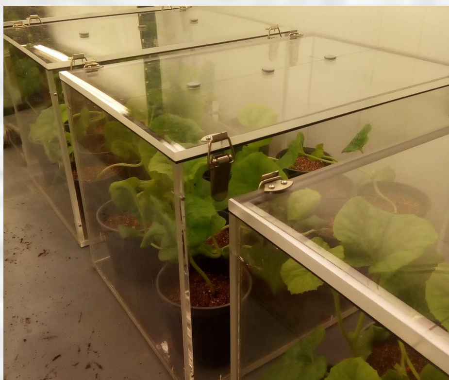
Cámara de incubación 18h de luz a 25°C y 8h de oscuridad a 18°C.
