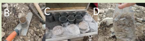
Figura 3. Diseño experimental en el campo (A). Toma y transporte de muestras sin alterar (B y C) y alteradas (D).
