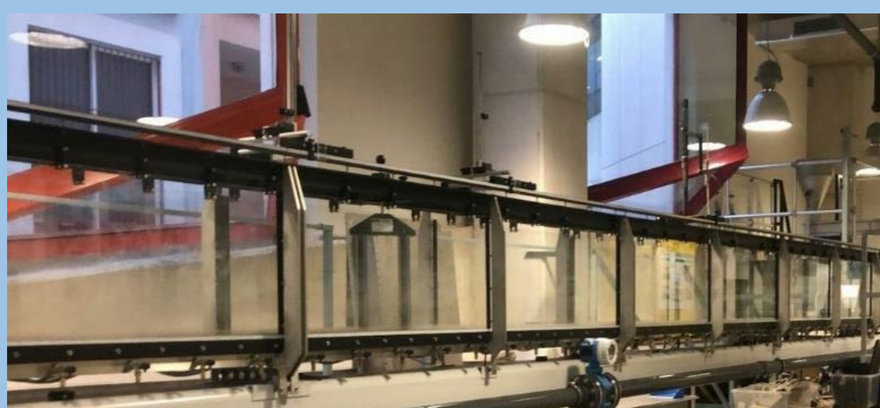
Canal (QR→funcionamiento) Ancho transversal: 0,31m Altura del cristal: 0,45m Longitud: 12,5m
