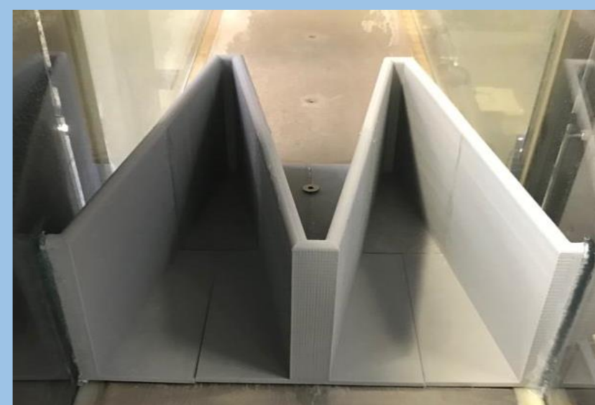
Aliviadero tipo laberinto Ancho transversal:0,31m Altura:0,15m Angulo:10°
