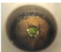
Foto 1. Medida de potencial hídrico de tallo con cámara de presión.
