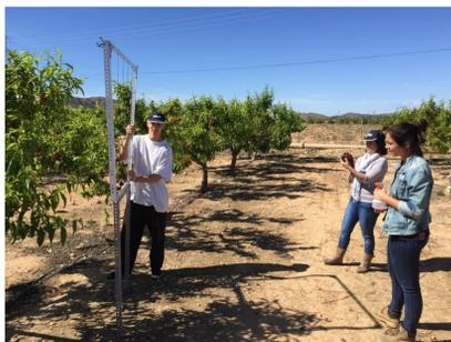
Foto 3. Medida de la temperatura de la cubierta vegetal con cámara termográfica.
